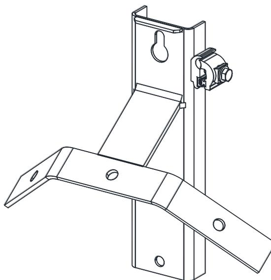
**НАЗНАЧЕНИЕ:** Применяется для крепления ограничителей перенапряжения на железобетонных опорах.
