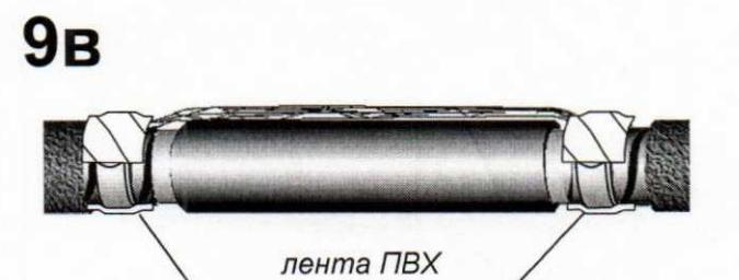
Лентой ПВХ (липкой) обмотать роликовые пружины с заходом на броню кабеля не более 5 мм.
