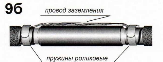
Для кабеля с пластмассовой изоляцией крепление провода заземления к бронелентам произвести с помощью двух роликовых пружин, предварительно зачистив и обезжирив поверхность бронелент.
