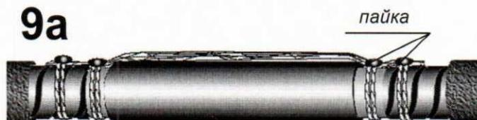
Закрепить провод, восстанавливающий электрическую связь оболочек кабелей, проволочными бандажами на облуженных участках брони и оболочек. Припаять восстанавливающий провод к броне и оболочке кабеля с бумажной изоляцией.
