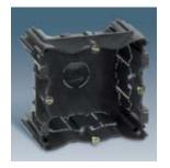
31710 -61 Прямоугольная коробка для скрытого монтажа, 1 пост, со съёмными боковыми перегородками, 75 x 70 x 43 мм, м/у винтами 60 мм, термопластик
