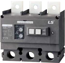
Автоматический выключатель может обеспечивать защиту по току утечки, если он оборудован устройством дифференциального тока (RCD). Автоматические выключатели TS100, TS160 и TS250 могут объединяться с устройством дифференциального тока RTU23, TS400 и TS600 - с RTU33, а TS800 - с RTU43. Во всех случаях RCD крепится снизу прямо к выключателю без использования дополнительных проводов или перемычек.
