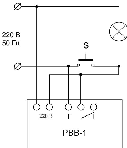
*При нажатии на кнопку “S” включаются реле, лампочка и замыкаются нормально разомкнутые контакты реле, которые фиксируют цепь питания реле и лампочки после отпускания кнопки. По истечении 5-ти минут контакты размыкаются и отключают лампочку и реле.*
