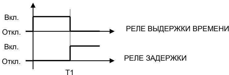
Для работы в режиме “РЕЛЕ ВЫДЕРЖКИ ВРЕМЕНИ” должна гореть точка в правой части индикатора у указателя “”. Для работы в режиме “РЕЛЕ ЗАДЕРЖКИ” точка должна быть погашена. Выбор этого режима производится при удержании кнопки “” (выдержка/задержка). Режим устанавливается для всех временных диапазонов.
