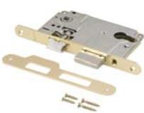
Замок с защелкой "собачка". Устанавливается в комплекте с дверными ручками 66406 - 66438, цилиндрическими механизмами 67220 - 67240 и накладками 66472 - 66477, соответствующих цветов. Дверные ручки управляют механизмом защелки. Цилиндрический механизм управляет механизмом замка. Накладки выполняют декоративную функцию окантовки цилиндрического механизма. Комплектация: ответная планка и крепеж. Упаковка: блистер.
