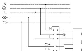
3. Схема підключення світильника до мережі живлення з регульованим драйвером по системі DALI .
