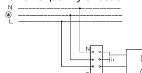
2. Шамшырақты 1-10V системасы арқылы реттеулі қуат беруші сымға жалғау схемасы.
