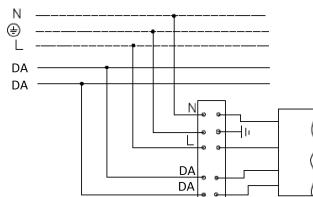
4. Схема підключення світильника до мережі живлення з блоком резервного живлення.
