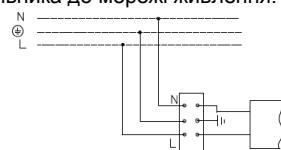
2. Схема підключення світильника до мережі живлення з регулюванням по системі 1-10V.
