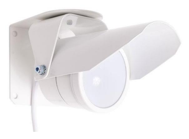
Извещатель пожарный пламени Тюльпан 1-1-2 предназначен для обнаружения электромагнитного излучения пламени в инфракрасном диапазоне с максимумом спектральной чувствительности на λ=4,4 мкм и выдачи извещения о пожаре.
