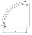
Крышка угловой секции 90° с предварительно установленными зажимами.
