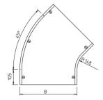
Крышка угловой секции 45° с предварительно установленными зажимами.
