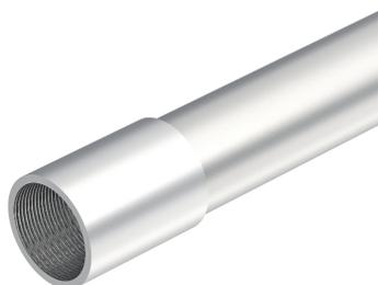
Электромонтажная труба согласно EN 61386-1 с резьбой на концах согласно DIN EN 60423 для механической защиты кабеля и проводов. С внутренней стенкой без заусенцев. На каждую трубу накручивается соединительная муфта.
