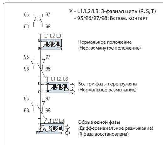
◆ Замыкающая и размыкающая способность вспомогательных контактов
