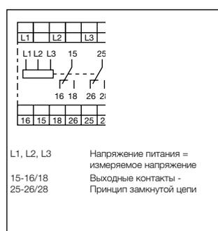
Схема подключения CM-PAS.x1
