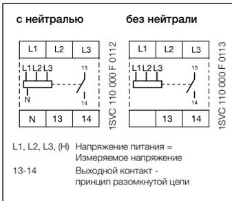
Схема подключения CM-PVS.x1
