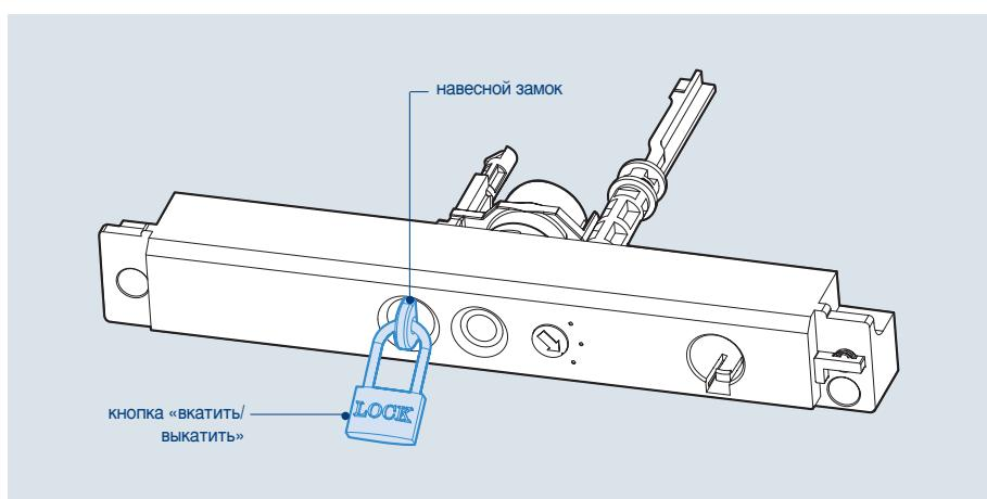
Автоматический выключатель может перемещаться из положения «установлен» через положение «выкачен для тестирования» в положение «выкачен», и обратно. В каждом из этих положений автоматический выключатель может быть зафиксирована навесным замком.
