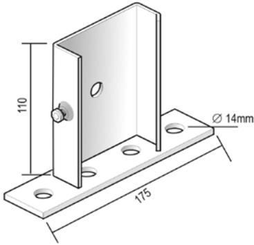
Для крепления кабельного лотка лестничного типа вертикально к полу
