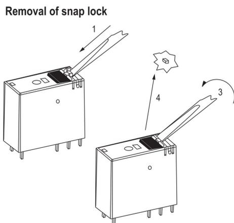
Удаление стопорной защелки кнопки испытания
