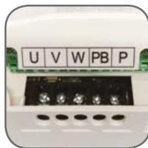
Встроенный тормозной модуль
