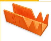
Стусло монтажное – приспособление из ударопрочной пластмассы для фасонной резки трубок Energoflex® с наружным диаметром до 89 мм.
