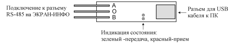
Рисунок 6. Расположение контактов преобразователя ПИ1.
