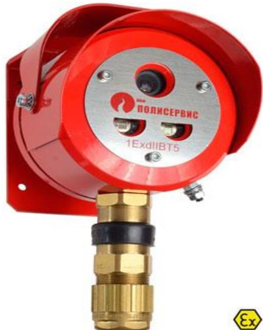
Извещатель пожарный пламени Тюльпан 2-23В предназначен для обнаружения электромагнитного излучения пламени в инфракрасном диапазоне с максимумом спектральной чувствительности на  $\lambda_1=4,4$  мкм и выдачи извещения о пожаре. Оснащен опорным каналом на  $\lambda_2=4,0$  мкм и встроенной ТВ-камерой.
