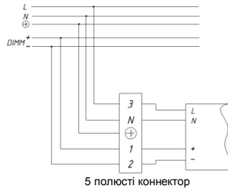
4-сурет. Диммирлеуші драйвері бар электрлік қосылыстардың сұлбасы
