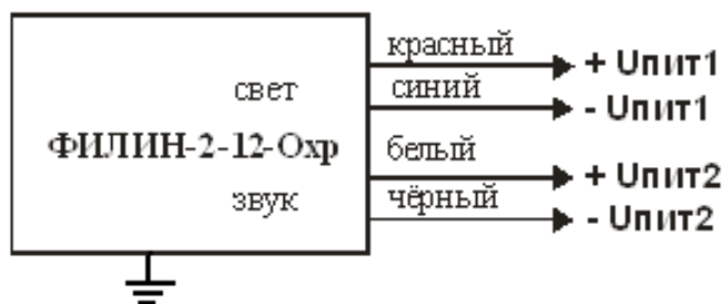
Рис. Б.3 Схема подключения оповещателей модели ФИЛИН-1-12-Охр с отдельным питанием электрических схем звукового и светового сигнала. При подаче напряжения Упит1 включается световой сигнал, Упит2 – звуковой сигнал. Диапазон подключаемых напряжений 10,6...28,0 В постоянного напряжения. Электрические схемы светового и звукового сигналов гальванически развязаны.
