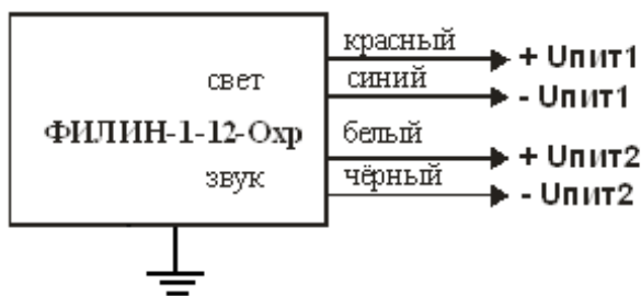
Рис. Б.3 Схема подключения оповещателей модели ФИЛИН-1-12-Охр с отдельным питанием электрических схем звукового и светового сигнала. При подаче напряжения Упит1 включается световой сигнал, Упит2 – звуковой сигнал. Диапазон подключаемых напряжений 10,6...28,0 В постоянного напряжения. Электрические схемы светового и звукового сигналов гальванически развязаны.
