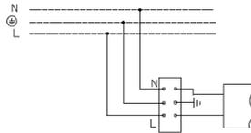
2. Схема подключения светильника к питающей сети с блоком резервного питания (на рис. а - блок резервного питания).
