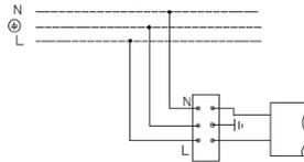
2. Схема підключення світильника до мережі живлення з блоком резервного живлення (на мал. а - блок резервного живлення).
