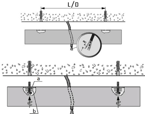
3. Корпус зафиксировать на опорной поверхности в заранее подготовленных отверстиях при помощи комплекта крепежа.
