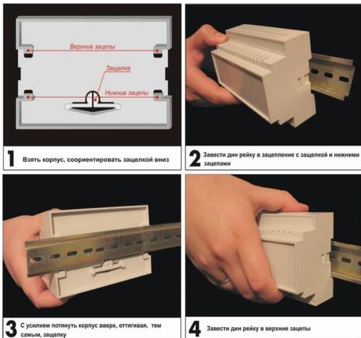
Для снятия корпуса с DIN рейки:
