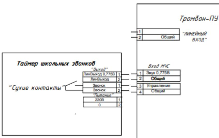
Примечание! Прибор опционально поставляется с "сухими контактами" на разъёме «Зв.» (Звонок) и напряжением в 0.775В на разъёма «ЛинВых».
