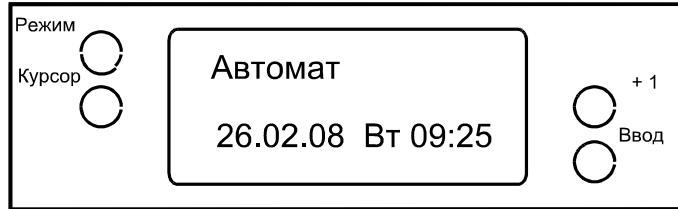
На лицевой панели прибора расположены клавиатура и дисплей. Клавиатура устроена таким образом, что реакция на нажатие кнопки происходит в момент отпускания нажатой кнопки. Далее по тексту будет говориться "нажмите кнопку..." или "при нажатии на кнопку ...", при этом следует иметь в виду, что необходимо нажать и затем отпустить указанную кнопку. Переключение режимов производится последовательным нажатием кнопки **Режим**.
