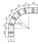
Для придания устойчивости конструкции в области фасонных деталей необходимы дополнительные опоры.
