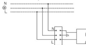
2. Схема підключення світильника з датчиком руху (MS) до мережі живлення.
