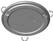
4. Желілік сымдарды шамдалға (Ø6-12 мм) герметикалық оқшаулағыш арқылы өткізіңіз. Корпусты тіректік бетке бекітіңіз
