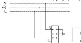
3. Схема підключення світильника до мережі живлення з регульованим драйвером по системі DALI .
