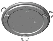
4. Провести мережеві дроти (Ø6-12 мм) в корпус світильника через гермоізолятор. Корпус зафіксувати на опорній поверхні.
