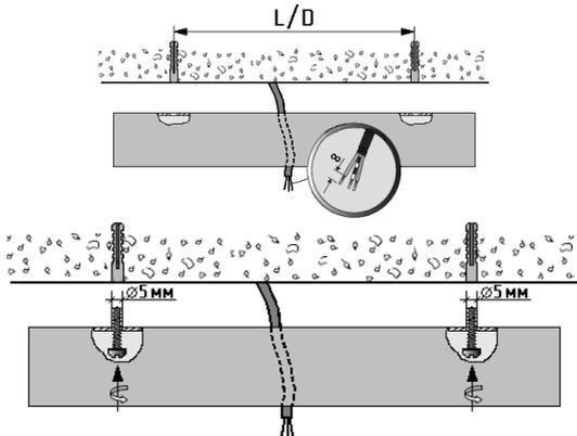
5. Подключить сетевые провода, соблюдая полярность (усилие затяжки винтовых зажимов 2,5 Нм). При использовании диммируемого драйвера, управляющие провода подключаются строго с соблюдением полярности, указанной в маркировке.
