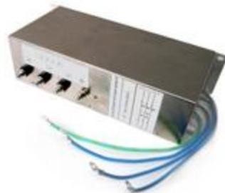
ЭМИ-фильтры применяются для уменьшения электромагнитных помех, излучаемых в сеть при работе преобразователя частоты. Фильтры рекомендуется использовать, если электропитание преобразователя частоты осуществляется от одного ввода совместно с другими устройствами, чувствительными к электромагнитным помехам (контроллеры, радиооборудование, компьютеры и т.п.).
