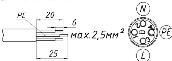
4. Зафиксировать провода винтами, собрать кабельный соединитель в обратной последовательности. Муфты затянуть с усилием 2,5Н·м.
