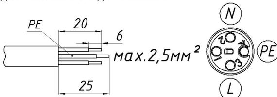
4. Зафіксувати дроти гвинтами, зібрати кабельний з'єднувач в зворотній послідовності. Муфти затягнути із зусиллям 2,5 Н·м.
