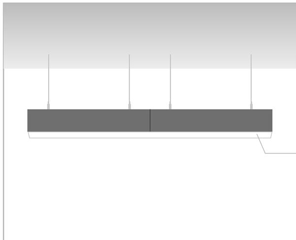
Рулонный рассеиватель до 30 м – обеспечивает непрерывность линии
