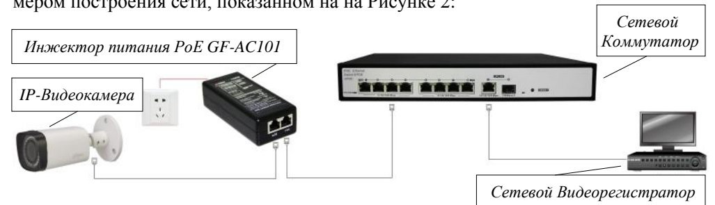
Рис. 2 Пример построения сети с подключением Инжектора питания PoE
