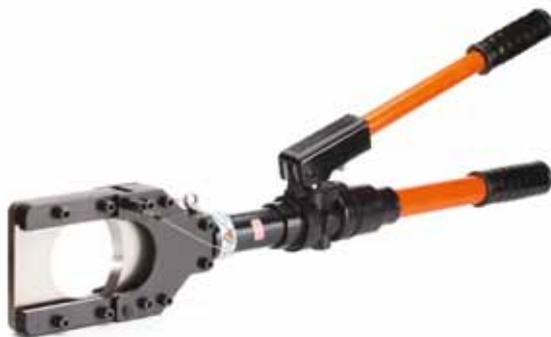
*“Автономный инструмент с интегрированной помпой. Сброс давления – поворотом рукоятки.”*
