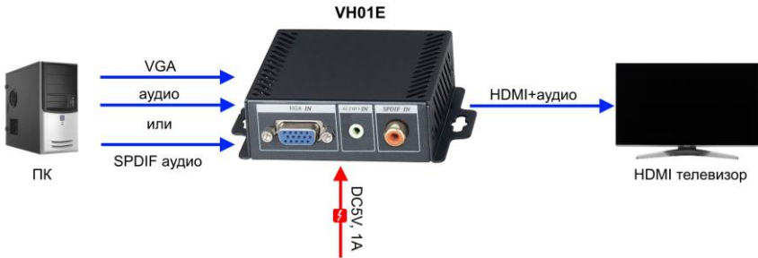
Рис.3 Типовая схема подключения преобразователя VH01E вместе с ПК
