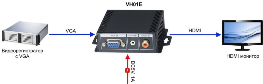
Рис.4 Типовая схема подключения преобразователя VH01E вместе с видеорегистратором
