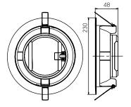
Размер светильника: 230x48mm Размер упаковки светильника: 235x235x52mm PF ≥0,9
