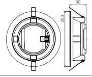
Размер светильника: 200x60mm Размер упаковки светильника: 205x205x63mm PF ≥0,9
