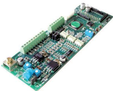
Плата сопряжения PG-B2 или PG-X2 предназначена для подключения датчика скорости (тахогенератора) с импульсным выходом к преобразователю частоты (**только EI-9011, EI-9013**). В зависимости от характеристик датчика скорости может использоваться одна из двух модификаций платы. Характеристики плат представлены в табл. 7.
