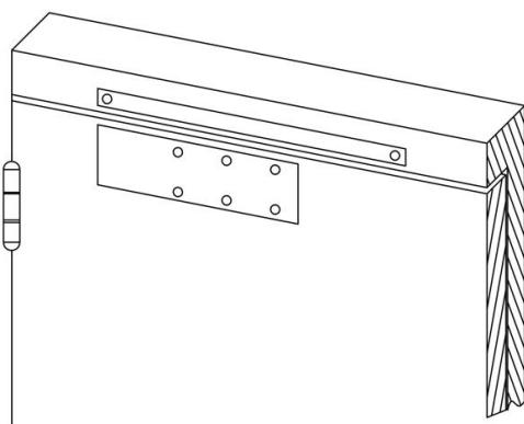
Разметьте 4 отверстия на дверном полотне для доводчика и 2 отверстия на дверной раме для направляющей.
