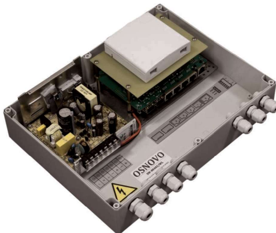
Рис. 2 Уличный коммутатор SW-80402/WL, внешний вид внутри
