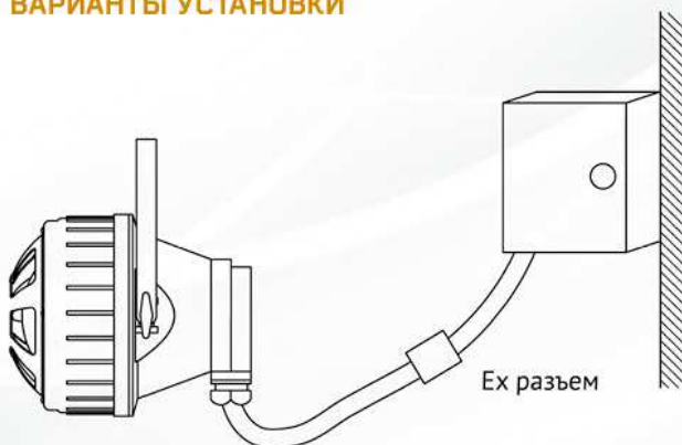
Подключение светильника во взрывоопасной зоне
