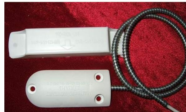
Контакты извещателя при работе на магнитопроводных поверхностях находятся в замкнутом (переключенном) состоянии при расположении магнита и датчика: на расстоянии 25 мм и менее (для изделий 6) на расстоянии 12 мм и менее (для изделий 7), и в разомкнутом (не переключенном) состоянии на расстоянии 70 мм и более.
