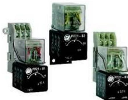
Реле **РП21М-003В1**, **РП21М-002В2** предназначены для коммутации электрических цепей с определенными, предварительными установленными выдержками времени, а **реле РП21М-003В3** - для автоматического циклического включения и отключения электрических цепей, например, для питания световой сигнализации (получения мигающего света).
