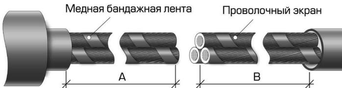
**2.1** Удалить с кабеля оболочку и межфазный наполнитель согласно рисунку и таблице (разделка на размер А должна проводиться со стороны кабеля с надетым кожухом).
