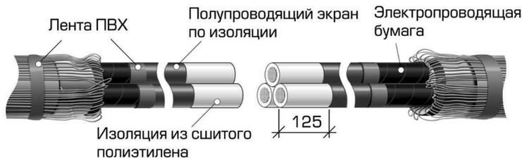
**4.1** Специальным инструментом (роликовым ножом) удалить слой черного полупроводящего экрана по изоляции из экструдированного сшитого полиэтилена с каждой жилы обоих концов кабеля на длину 125 мм от среза кабеля.
