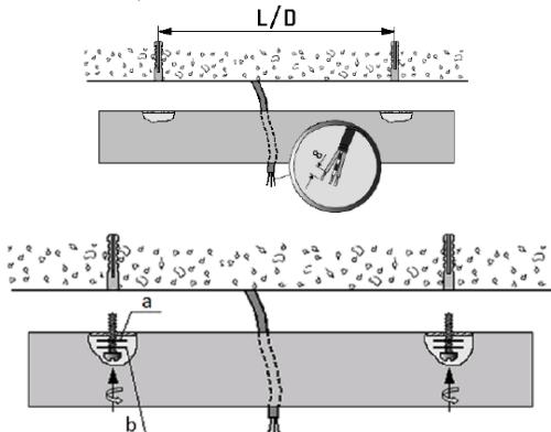
3. Підключити мережевий провід до клемної колодки відповідно до зазначененої полярності.
