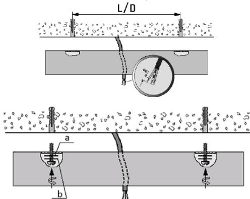
3. Подключить сетевой провод к клеммной колодке в соответствии с указанной полярностью.
