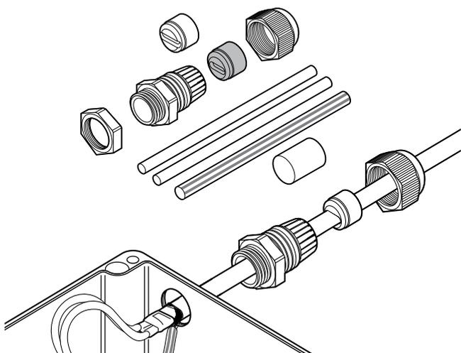
Подсоединительные наборы nVent RAYCHEM C25-21 предназначены для подсоединения греющих кабелей nVent RAYCHEM BTV, QTVR, XTV, KTV или VPL к соединительной коробке с обеспечением электрической изоляции медных жил и саморегулируемого токопроводящего греющего элемента. Изоляция греющего элемента греющего кабеля осуществляется термоусаживаемой манжетой. Две уплотнительные втулки в составе комплекта обеспечивают оптимальное уплотнение сальника для различных типов греющих кабелей.
