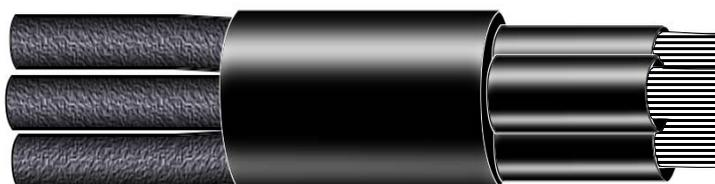
На кабели с полиэтиленовой изоляцией надеть перчатку ТУП 70-120-1 для сечение 35-50 мм, и ТУП 70-240 для сечения 70-240мм так, чтобы пальцы перчатки были направлены в сторону кабелей с полиэтиленовой изоляцией и продвинуть её по кабелям на длину около 1м.
