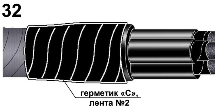
Лентой № 2 герметика «С» обмотать корпус перчатки до основания пальцев.
