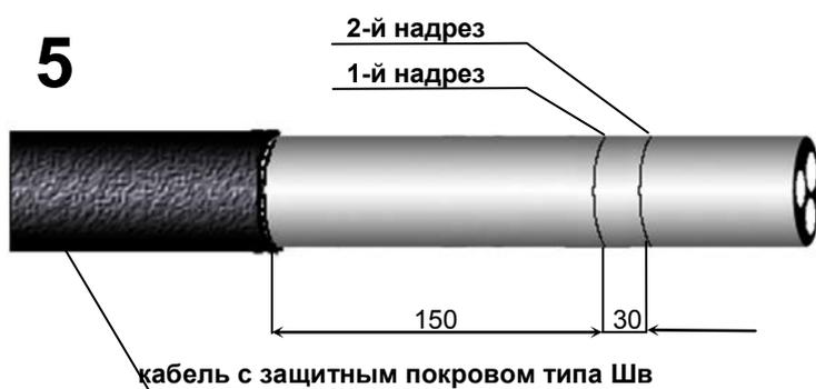
Удалить бронеленты с конца кабеля до бандажа (рис.5а), шланг до кольцевого надреза (рис.5). Очистить ветошью, смоченной бензином, бронеленты на длине не менее 150 мм, оболочку на длине не менее 250 мм от бандажа или среза шланга в сторону конца кабеля. На расстоянии 200 мм от среза бронелент или шланга выполнить на оболочке кольцевой надрез на половину толщины оболочки и на расстоянии 30 мм от нее – второй кольцевой надрез.
