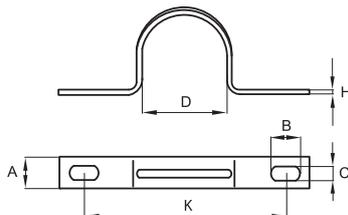
**Назначение:** для крепления пластиковых, металлических, металлопластиковых труб, а также кабеля к поверхности стен, потолков, полов и перегородок
