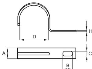
**Назначение:** для крепления пластиковых, металлических, металлопластиковых труб, а также кабеля к поверхности стен, потолков, полов и перегородок
