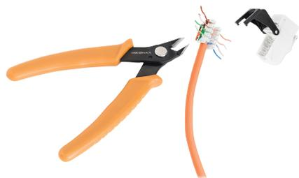
Боковые кусачки NMC-222 предназначены для точной обрезки жил проводов и других тонких электромонтажных работ. Длина режущей кромки кусачек – 10 мм. Подходят для жил из меди и других мягких металлов толщиной до 1 мм (18AWG). Не предназначены для стали.
