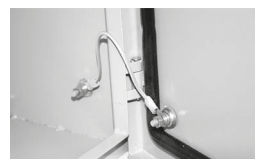
элементы заземления на двери корпуса; полиуретановый уплотнитель на двери (IP54)
