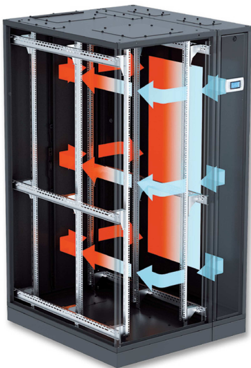
Серверный шкаф с боковым теплообменником. Ширина шкафа 800 мм, ширина теплообменника 300 мм. Двери шкафа с термостойким, каленым стеклом.
