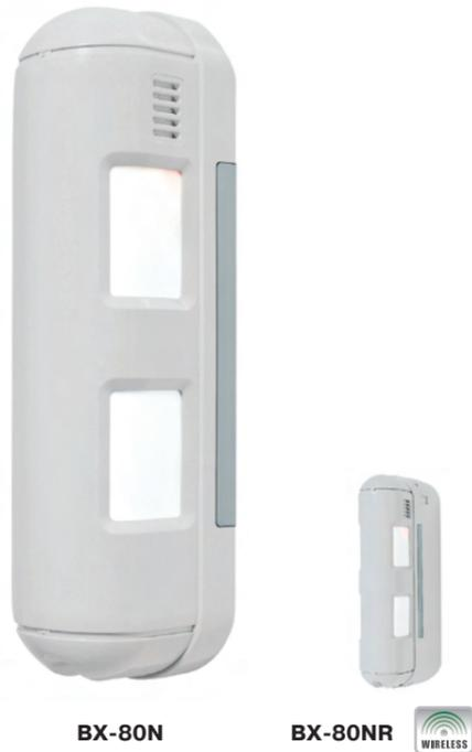
Извещатель BX-80N разработан специально для защиты фасадов зданий, устанавливается в центре зоны детекции и создает многолучевой барьер, направленный в две стороны. Во избежание нежелательной детекции посторонних объектов дальность действия извещателя может быть ограничена расстоянием 12, 8, 5 или 2 метра в каждую сторону.
