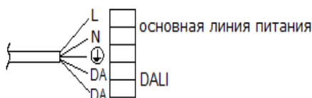
Рис.2. Схема подкл. свет. с управл. по протоколу DALI
