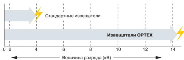
Улучшенная система защиты от высоковольтных разрядов – одно из главных преимуществ активных извещателей Optex серии AX, которые способны выдержать разряд до 15 кВ без каких-либо негативных последствий для их работоспособности (по результатам тестирования уровень защиты соответствует стандарту IEC801-5).
