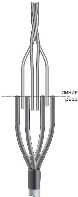
**6.1** Расплести провод на длине необходимой для соединения. Расположить провода СИП с нахлестом на жилы кабеля. Обрезать провода СИП на уровне концов жил кабеля.
